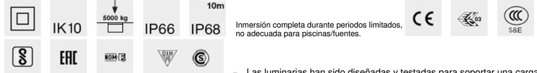
Las luminarias han sido diseñadas y testadas para soportar una carga estática de hasta 50000 N y son ideales para resistir el paso de vehículos con neumáticos. Las luminarias no pueden ser utilizadas en pasajes donde las luminarias se expongan a la tensión horizontal causada por la aceleración, frenado y / o cambios de dirección de los vehículos.
