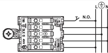
**IT** I dispositivi con cablaggio digitale possono essere dimmerati con dispositivi DALI o con pulsante normalmente aperto (N.O.) da collegare come da schema.
