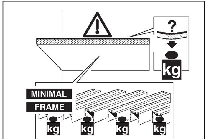
**IT** N.B.: E' responsabilità dell'utente verificare la resistenza del controsoffitto, in funzione del peso degli apparecchi installati.
