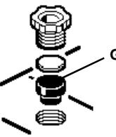
**RUS** При закрутке кабельного сальника проверьте, чтобы резиновая муфта «G» не выходила из своего гнезда с противоположной стороны.
