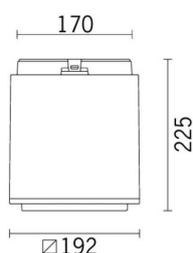
**Référence produit**BL24: Plafonnier d'extérieur - LED Blanc Chaud - transformateur électronique intégré Vin=de 120 à 240Vac - optique Very Wide Flood **Attention ! Code abandonné****Description technique**
