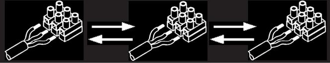
IT Cablare alla rete elettrica il trasformatore solo dopo aver effettuato il collegamento ai prodotti
