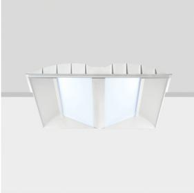
**Référence produit**P301: 625x625 - Neutral White - UGR<19 - DALI **Attention ! Code abandonné****Description technique**Appareil à encastrer sur faux-plafonds modulaires 625x625 mm, à émission directe, prévu pour l'utilisation de LED tonalité Neutral White 4 000K. Groupe optique en matière thermoplastique pour émission à luminance contrôlée UGR<19 L<3000 cd/m<sup>2</sup> α 65°, indiqué pour les lieux équipés d'écrans d'ordinateur. Le produit comprend le ballast DALI.**Installation**
