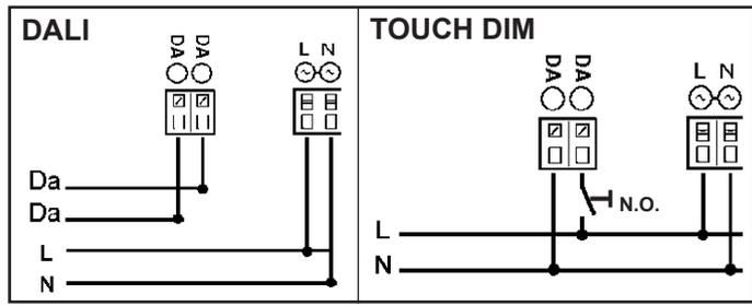
IT I dispositivi con cablaggio digitale possono essere dimmerati con dispositivi DALI o con pulsante normalmente aperto (N.O.) da collegare come da schema.
