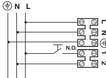
AR يمكن أن يتم تخفيض إضاءة الأجهزة ذات الكابلات الرقمية، وذلك عن طريق استخدام أجهزة الإمداد بالطاقة الكهربائية "دالي" (DALI)، أو عن طريق استخدام زر يكون مفتوحاً في وضعه الطبيعي (N.O.)؛ حيث يتم التوصيل كما هو مبين في المخطط.
