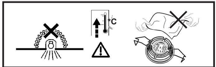
IT N.B.: Apparecchi non idonei ad essere coperti di materiale termicamente isolante
