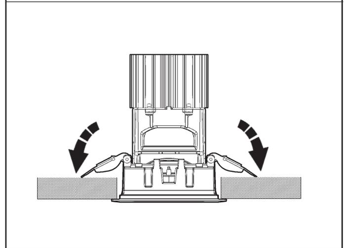
INSTALLAZIONE DEGLI ACCESSORI - INSTALLING THE ACCESSORIES
