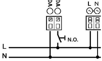
يمكن أن يتم تخفيض إضاءة الأجهزة ذات الكابلات الرقمية، وذلك عن طريق استخدام أجهزة الإمداد بالطاقة الكهربائية "دالي" (DALI)، أو عن طريق استخدام زر يكون مفتوحاً في وضعه الطبيعي (N.O.)، حيث يتم التوصيل كما هو مبين في المخطط.
