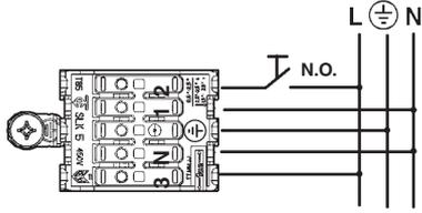
**AR** يمكن أن يتم تخفيض إضاءة الأجهزة ذات الكابلات الرقمية؛ وذلك عن طريق استخدام أجهزة الإمداد بالطاقة الكهربائية "دالي" (DALI)، أو عن طريق استخدام زر يكون مفتوحاً في وضعه الطبيعي (N.O.)؛ حيث يتم التوصيل كما هو مبين في المخطط.
