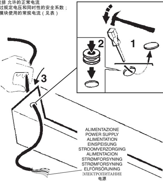
**IT** Utilizzare l'art. MZ91 ogni qual volta è necessario effettuare una nuova calata di alimentazione . (vedere tabella delle correnti massime ammissibili.)
