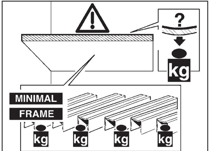
IT N.B.: E' responsabilità dell'utente verificare la resistenza del controsoffitto, in funzione del peso degli apparecchi installati
