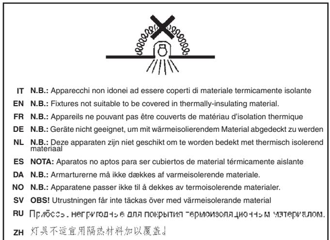
IT N.B.: Apparecchi non idonei ad essere coperti di materiale termicamente isolante
